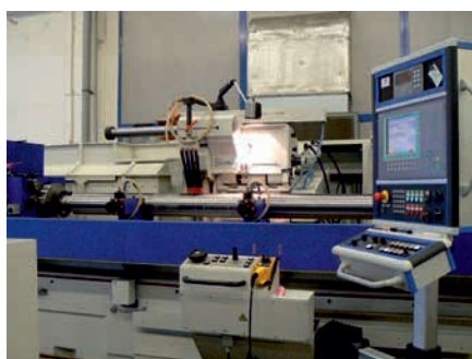
Сверхточное изготовление и посадка шпинделя с точностью до 0,001 мм
