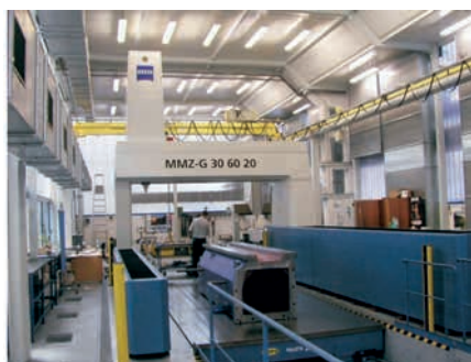
Контроль изготовления деталей в термоконстантной лаборатории с применением КИМ Zeiss
