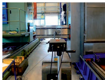
Лазерное измерение точности установки компонентов
